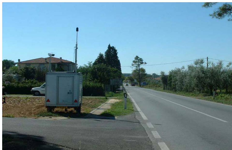
Esempio di postazione mobile per il monitoraggio del rumore stradale, in dotazione presso ARPAT. Sono visibili l'asta microfonica e la telecamera per il conteggio dei transiti veicolari.
