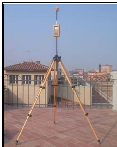
Fig. 2 – strumento di misura a Banda Larga con cavalletto dielettrico
