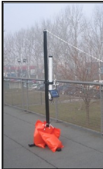
Fig. 5 – stazione di monitoraggio tri-banda
