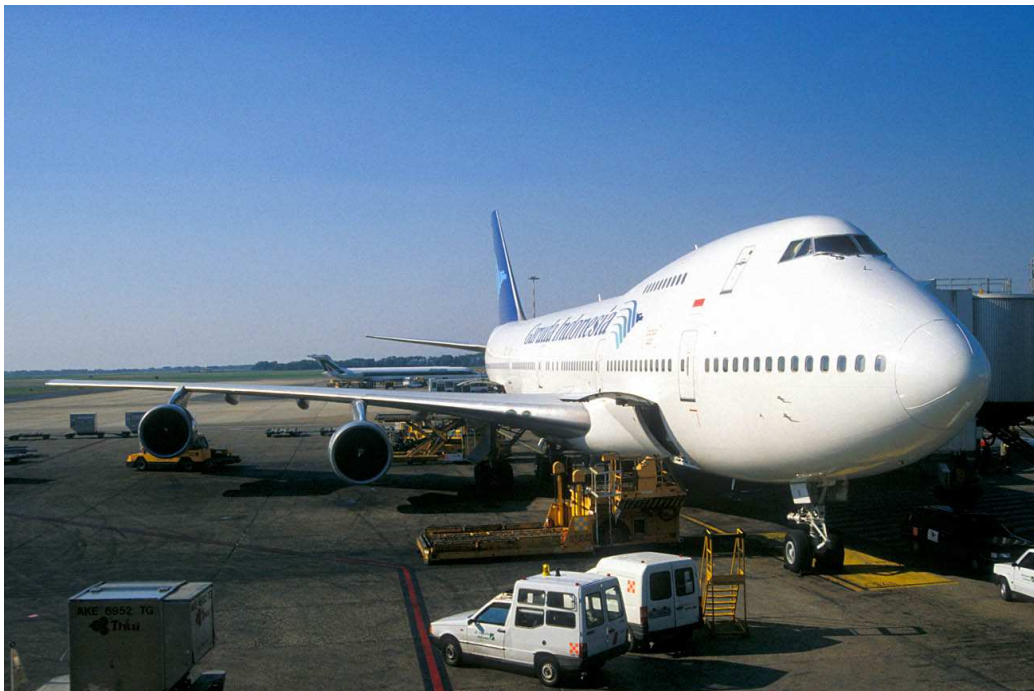
Figura 1.4: GSE di servizio presso un Boeing 747-200 all'aeroporto di Fiumicino
