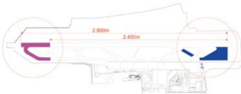
**Fig. n. 5** - Nuova configurazione dell'Aeroporto con pista di volo allungata.
